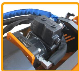
Motore idraulico a pistoni con valvole di sicurezza
