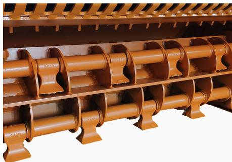
**ET/FM** è una trinciatrice compatta dotata di rotore forestale con *mazze mobili a 360° a scomparsa e doppio taglio*. Ideale per la trinciatura di erba, cespugli e ramaglia fino a 12 cm di diametro.
