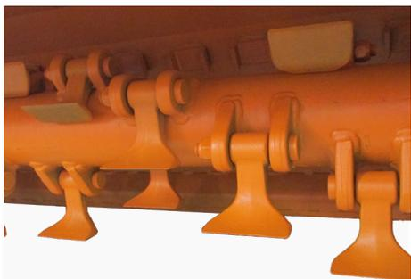
**ET/M** è equipaggiata di serie con rotore a mazze di tipo "D" (coltelli "YB" a richiesta). Ideale per la trinciatura di erba, cespugli e ramaglie fino a 8 cm.
